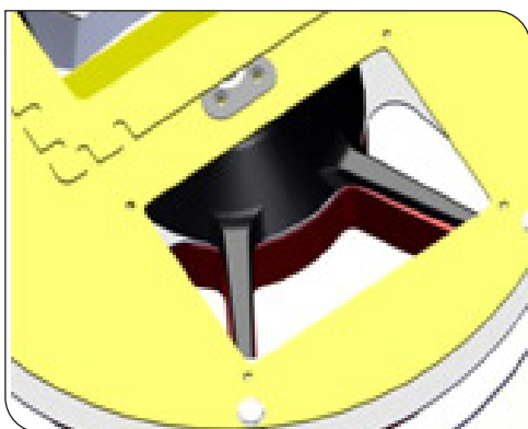
Illustrasjon 29: Korrekt og feil plassering av rotor i doserer, sett ovenfra
