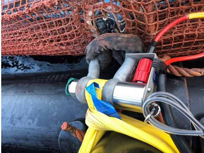
Figur 19 Lastsjakler montert i taket inn mot flytering (venstre bilde) og i kjetting mellom koblingsplate og bøye (høyre bilde)
