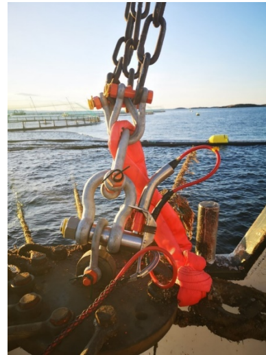
Figur 19 Lastsjakler montert i taket inn mot flytering (venstre bilde) og i kjetting mellom koblingsplate og bøye (høyre bilde)
