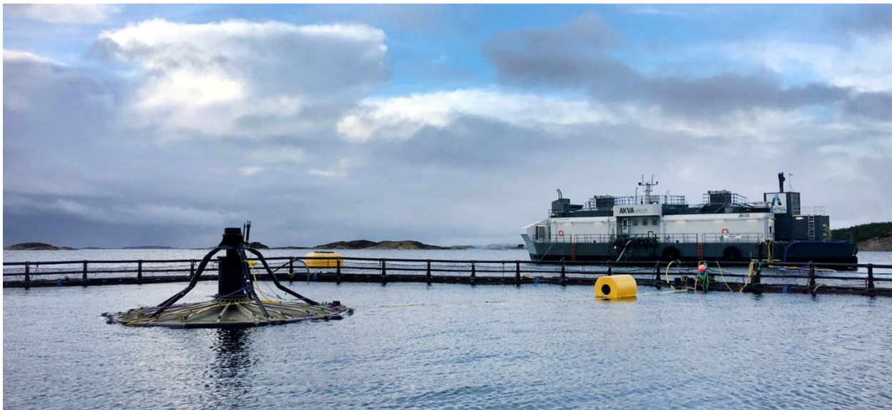
Figur 1 Nedsenkbar merd med flåte, container og styring
