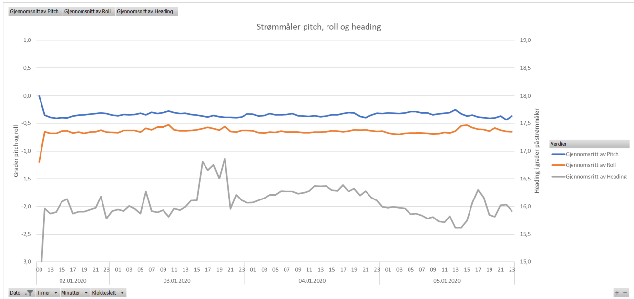
Figur 8 Måling av pitch, roll og heading i strømmåler montert på luftkuppel.
